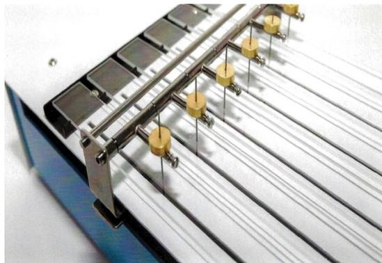
Al igual que los modelos tradicionales, el BK Variable ofrece una calidad optima en sus materiales. En la fotografía se muestra el soporte con las seis agujas de punta semiesférica que se desplazan a lo largo de seis tiras de vidrio de 305 x 25 mm a la velocidad seleccionada para el ensayo, entre las 20 pre-programadas (de 7,5 minutos a 96 horas).
