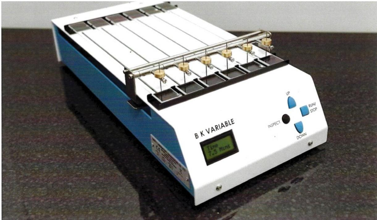
Los registradores BK de tiempo de secado se han usado ampliamente durante décadas en todo el mundo en la industria de pinturas y recubrimientos, siendo los modelos de referencia por su fiabilidad
