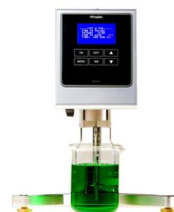
La serie **EVO Expert** tiene funciones adicionales para el estudio y comparación de productos: pantalla gráfica para programar rampas y escalones, visión de curvas de viscosidad en tiempo real, selección entre 2600 velocidades, comunicación USB y Bluetooth bidireccional para completo control desde el PC o dispositivo móvil.
