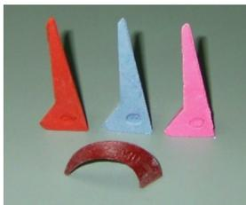
Conos pirométricos de fusión para control de temperatura en hornos cerámicos. Actúan como testigo del proceso de temperatura/tiempo y se doblan cuando el calor absorbido alcanza un determinado valor. Distintos números de conos con temperaturas equivalentes de 600 a 1800°C, con colores diferentes para facilitar la visión de resultados. El ángulo de doblado nos puede indicar la temperatura equivalente con precisión  $\pm 2^\circ\text{C}$ .
