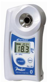
Refractómetros analógicos y digitales para la determinación del contenido de azúcar en alimentos, zumos, vino. Refractómetros de alta precisión para control de calidad en cosméticos, materias primas industriales, concentración de productos y soluciones acuosas. Distintos rangos entre 0 y 90% Brix. Modelos con compensación automática de temperatura (ATC).
