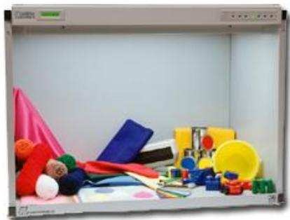
Para el control visual del color de pinturas, plásticos, textiles, cueros, cerámicas, tintas, cosméticos y otros productos coloreados. Las cabinas de luces de GTI Graphic Technology se basan en BS-950, ASTM D1729 y normas equivalentes. Desde modelos grandes con muebles opcionales hasta modelos pequeños, económicos o portátiles.
