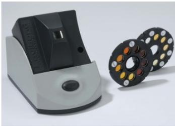
Todos los modelos permiten obtener las coordenadas de color  $L^*a^*b^*$  además de otros códigos e índices de color, y diferencias entre patrones y muestras, con memoria de datos y conexión a ordenador. Los espectrofotómetros ofrecen además las curvas de reflexión (o también de transmisión en los modelos de sobremesa), y la posibilidad de utilizar distintos iluminantes y condiciones de ensayo. También tenemos comparadores visuales para obtener el índice Gardner de productos transparentes.
