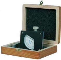
Durómetros Shore portátiles de mano o de sobremesa con cargas normalizadas para la medida de la dureza de plásticos, gomas y otros materiales.
