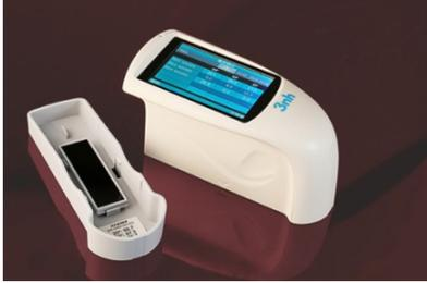
Para medir el brillo de superficies tenemos los instrumentos más competitivos, fiables y precisos, desde brillómetros económicos y simples hasta los modelos más completos y con conexión a ordenador. Se fabrican en versiones de uno y tres ángulos: 60° (geometría universal) o 20°-60°-85° (para mayor diferenciación de muestras muy mates o muy brillantes). Cumplen UNE EN ISO 2813, DIN 67530, ASTM D253, JIS 8741 y equivalentes.
